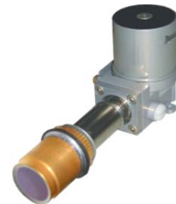
МФПУ нового поколения формата 640x512 элементов на основе фотодиодов из антимонида индия для области спектра 3–5 мкм
