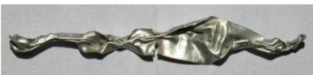
Рис. 7. Полоска Al фольги, деформированная под действием магнитной волны, прошедшей вдоль полоски
