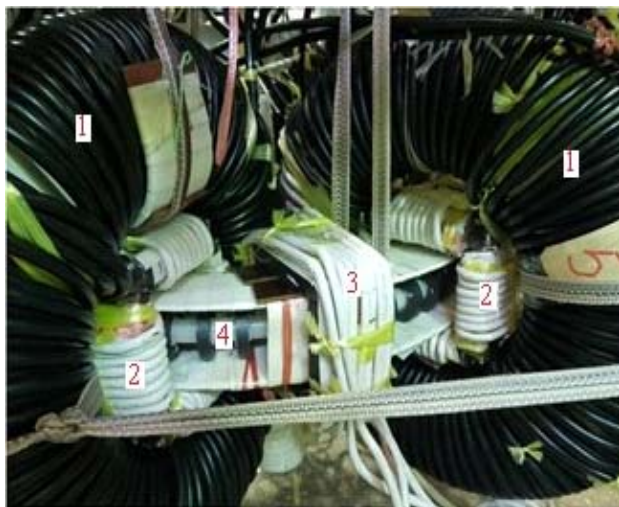
Рис. 4. Фото фрагмента установки с плазменной камерой и тремя уровнями магнитных линз: 1,2 – тороиды; 3 – соленоиды; 4 – пучок частиц в камере, в магнитных линзах
