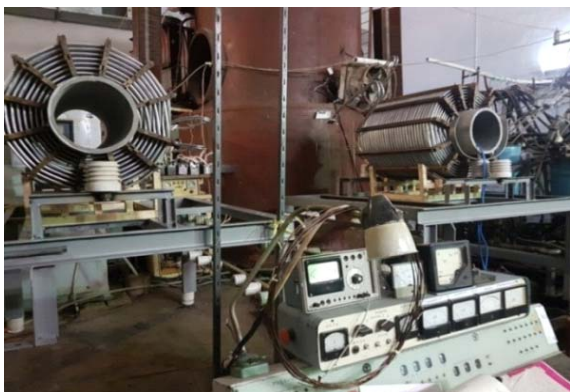
Рис. 8. Фрагменты MVD установки: два канала, независимо формирующих однополярные импульсы, которые при последующем наложении со сдвигом фазы на полпериода формируют на выходе синусоидальное ЭМ поле
