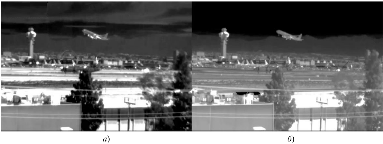
Рис. 5. Сравнение изображений в диапазоне 3–5 (а) и 8–10 мкм (б) получаемое днем в солнечную летнюю погоду (для задач обнаружения самолетов в переднюю полусферу)
