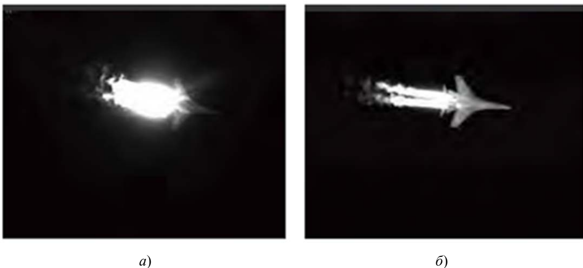
Рис. 8. Сравнение изображения самолета в диапазоне 3–5 (а) и 8–10 мкм (б)
