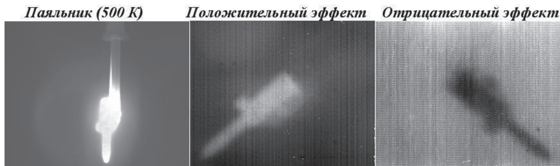
Рис. 1. Нагретый объект в поле зрения МФПУ (паяльник).
