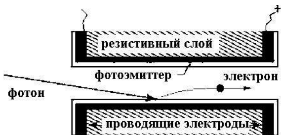
Рис. 2. Схема усилителя рентгеновского диапазона
