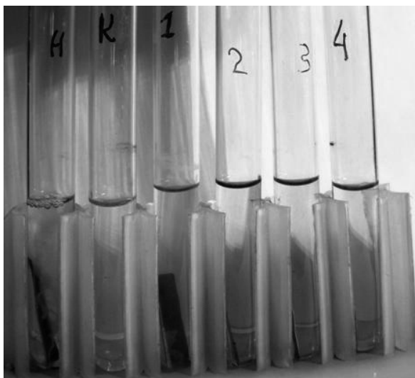
Рис. 3. Результаты бактерицидного действия холодной аргоновой плазмы. H — необработанная пластина; K — контроль; 1, 2 — обработка импульсной короной, t = 2 и 5 мин, соответственно; 3, 4 — обработка в режиме ТРАД, t = 2 и 5 мин, соответственно
