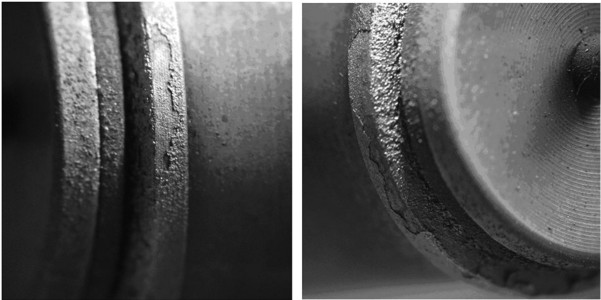
Рис. 4. Распыленные плёнки на поверхности поджигающей системы ИИ.
