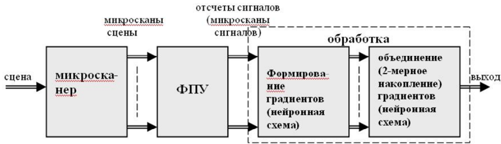
Рис. 1. Общая схема формирования изображения для ФПУ с микросканированием
