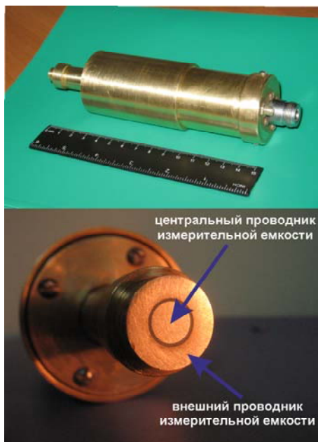
Рис. 8. Фотография резонансного датчика для ближнепольной СВЧ-диагностики биологических тканей. Измерительная часть датчика выполнена в виде краевой емкости цилиндрического конденсатора. Толщина внешней обкладки превосходит радиус центрального проводника
