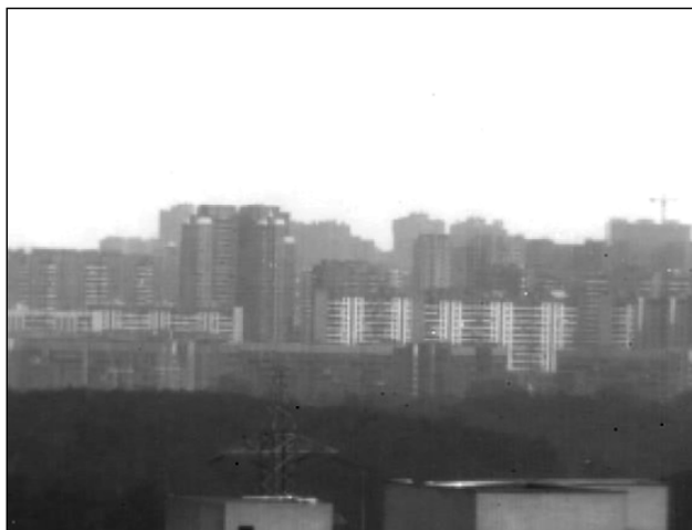
Рис. 19. Изображение видимо-слепого УФМ на основе ГЭС AlGaIn формата 320×256 с шагом 30 мкм
