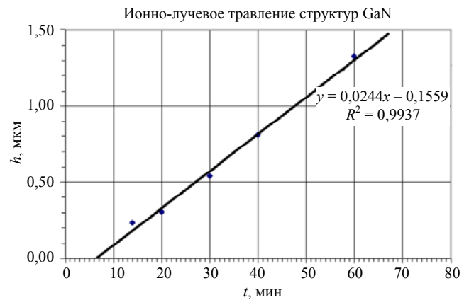
Рис. 10. Зависимость глубины ионно-лучевого травления от времени процесса
