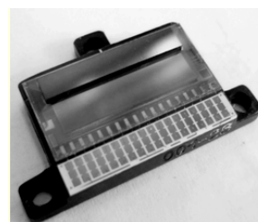
Рис. 3. Конструкция фотоприемного модуля 2-го типа
