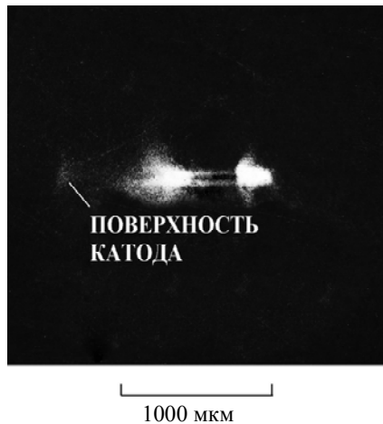
Рис. 5. Типичная обскурограмма \lambda < 1,5 нм, полученная за один разряд при угле раствора конического электрода 30^\circ
