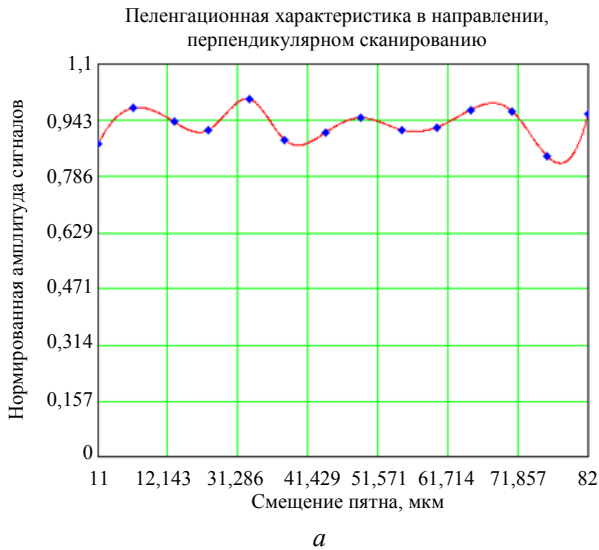
Рис. 5. Пеленгационные характеристики, полученные экспериментально (а) и теоретически (б)
