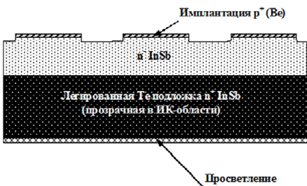
Рис. 7. Схема эпитаксиальной структуры InSb на основе мезотехнологии
