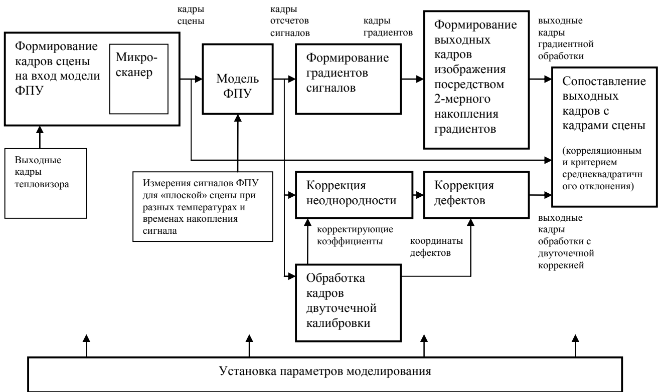
Рис. 1. Блок-схема моделирования микросканирования с градиентной обработкой изображения
