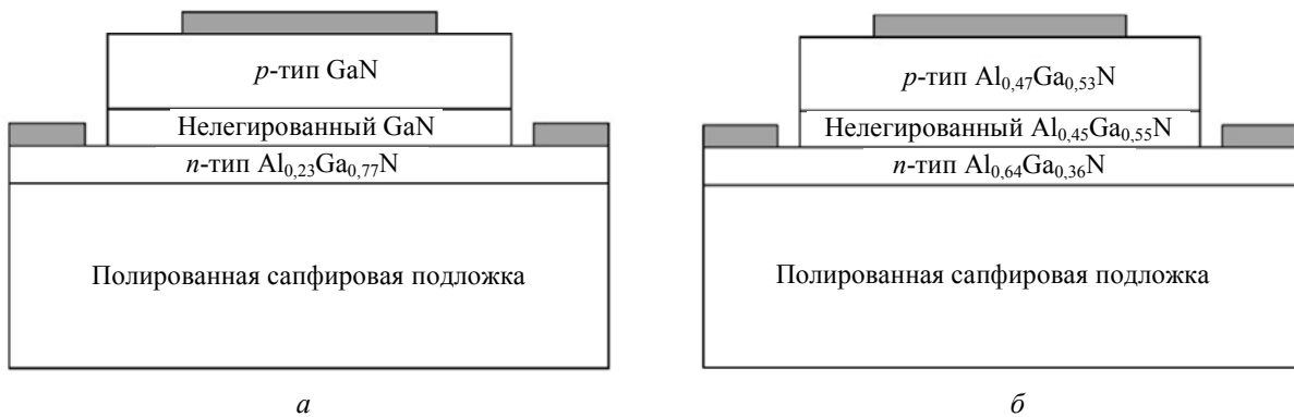
Рис. 2. Схематичное изображение структур, используемых для «видимо-слепых» (а) и «солнечно-слепых» (б) УФ-светодиодов
