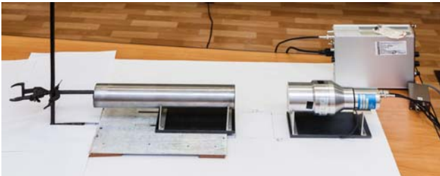
Рис. 4. Фото измерительной установки для измерения коэффициента attenuation гамма-излучения макетом LiH attenuатора.
