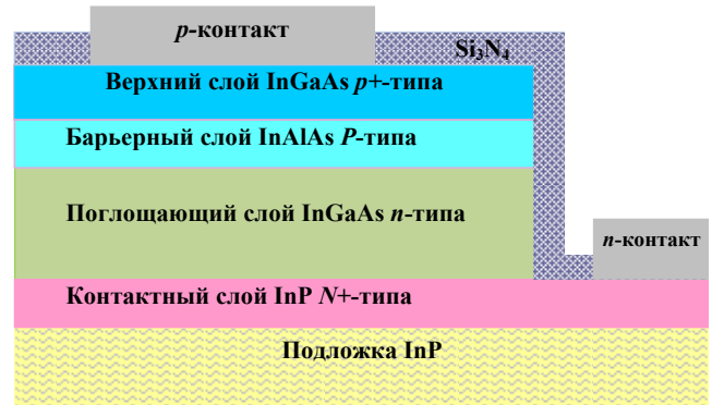
Рис. 1. Матрица фоточувствительных элементов на основе четырехслойной структуры p^+-B-n-N^+ -типа из ГЭС InGaAs.
