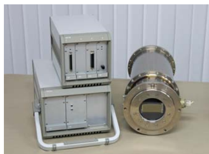
Рис. 1. Криостатируемая ПЗС-система (справа — азотный криостат с ПЗС-приемником CCD42-90 форматом 2К×4К, слева — блок питания (снизу) и ПЗС-контроллер).
