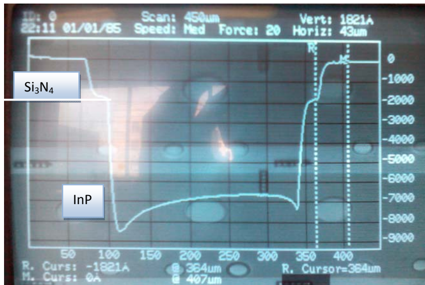
Рис. 4. Фото с экрана профилометра Dektak. Профиль окна под диффузию с углубленной центральной частью.
