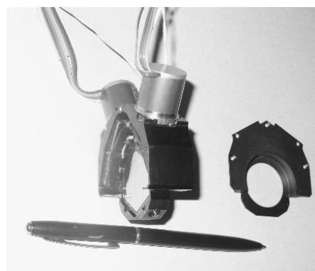
Рис. 2. Внешний вид электромагнитного микросканера на основе двух плоскопараллельных пластин со снятой крышкой.
