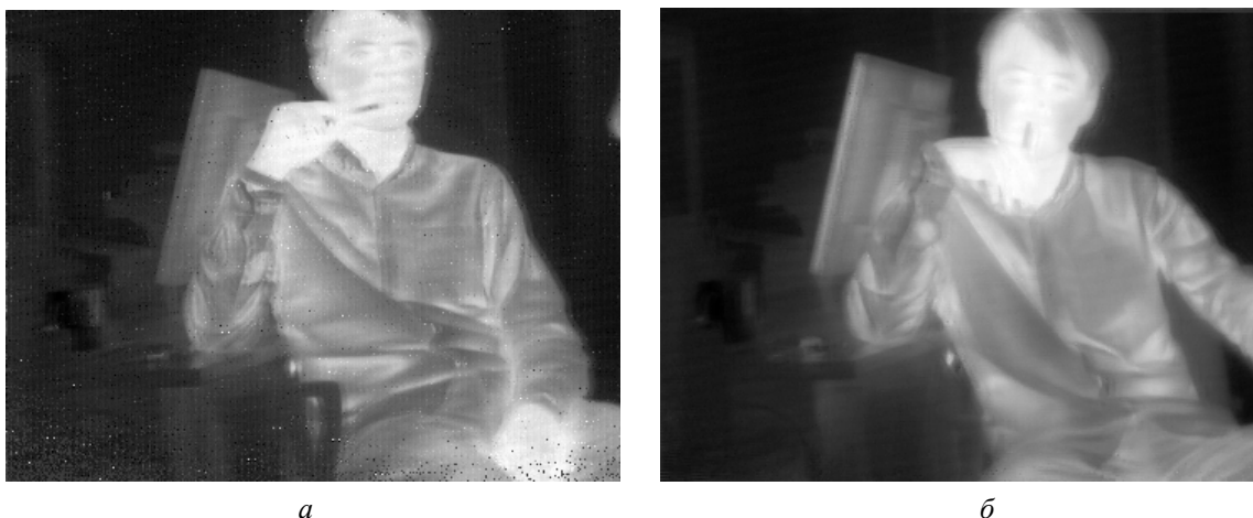
Рис. 5. Результаты фильтрации: а – исходное изображение; б – изображение после фильтрации.
