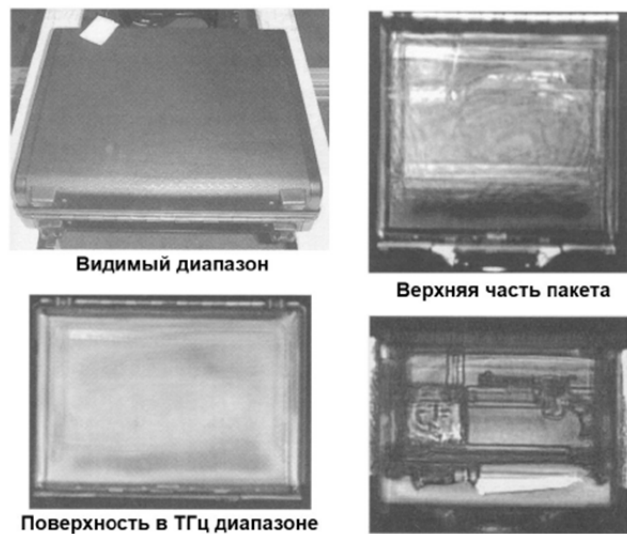
Рис. 5. Пример работы импульсной активной системы радиовидения, работающей с отраженным от объекта излучением [15]. Компенсация задержки в тракте сигнала позволяет получать изображения слоев, расположенных внутри исследуемого объекта. Слева сверху приведена фотография исследуемого объекта (чемодан) в видимом диапазоне частот. Слева внизу приведено терагерцовое изображение поверхности объекта. Справа сверху приведено терагерцовое изображение пакета, лежащего внутри чемодана. Справа внизу представлено терагерцовое изображение содержимого пакета. На последней картинке отчетливо видны нож и пистолет, лежащие внутри исследуемого багажа.
