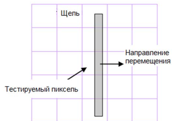
Рис. 6. Схема перемещения изображения тест-объекта по поверхности ФЧЭ, при измерении ЧКХ в установке BIRD210.
