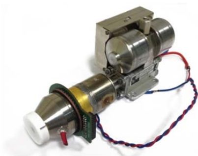
Рис. 4. Внешний вид матричного ФПУ формата 384×288 элементов.
