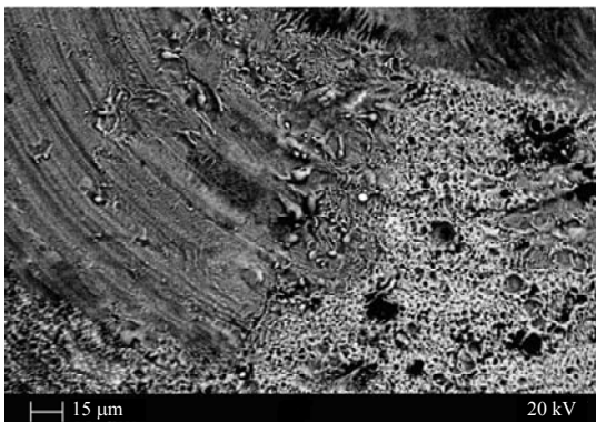
Рис. 4. Следы эрозии на поверхности катода. Микрофотография получена на сканирующем электронном микроскопе.
