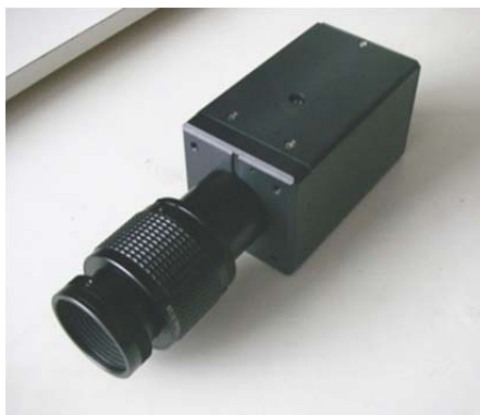
Рис. 9. УФ ТВ-камера (ФПУ с объективом).
