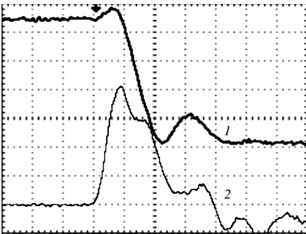
Рис. 4. Осциллограмма пробоя. Развертка 10 нс/дел. Луч № 1 – напряжение на промежутке катод-анод, чувствительность – 200 В/дел. Луч № 2 – ток поджига, чувствительность – 2 А/дел.
