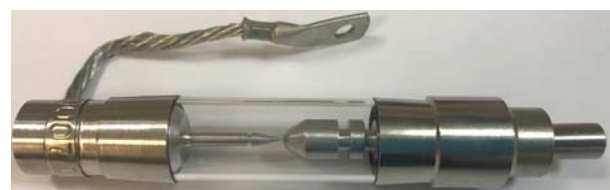
Рис. 2. Конструктивное исполнение ксеноновой лампы СВД с цилиндрической сапфировой оболочкой СПКс-500.
