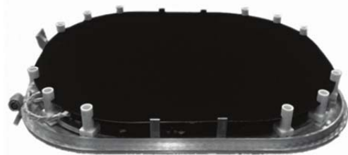
Рис. 7. Фотография модели протяженного АЧТ по [5].
