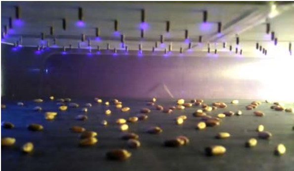
Рис. 1. Фотография свечения тлеющего разряда атмосферного давления. Межэлектродное расстояние d = 2 см.
