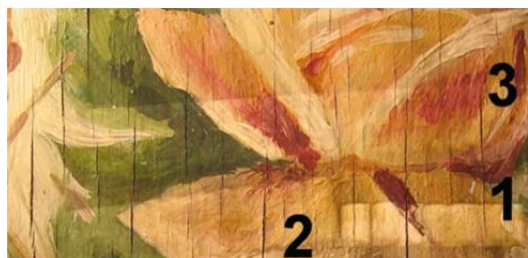
Рис. 3. Полосы воздействия лазерного излучения на покрытую копотью поверхность, 1 – H \approx 1 \text{ Дж/см}^2 , 2 и 3 – H \approx 0,64 \text{ Дж/см}^2 .
