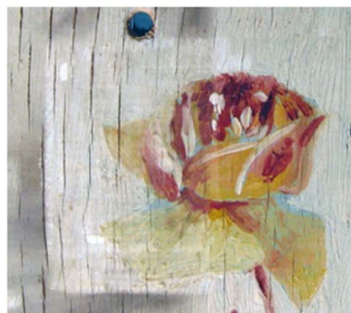
Рис. 5. Фрагмент картины, а – наполовину покрытый копотью, б – после воздействия лазерного излучения.
