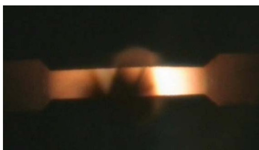
Рис. 4. Графитовый стержень на конечной стадии формирования облака ПТГ перед взрывообразным разрушением.
