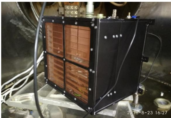
Рис. 2. Фотография научной аппаратуры в вакуумной камере ускорителя микрочастиц.
