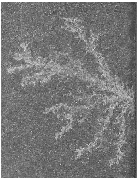
Рис. 6. Макрофотография зоны эрозии на поверхности пластины из титана, покрытой оксидной пленкой толщиной 10 нм, в результате возбуждения одиночного микроплазменного разряда с длительностью 100 мкс и амплитудой электрического тока 200 А. Размер изображения 7 \times 8,6 \text{ мм}^2 .
