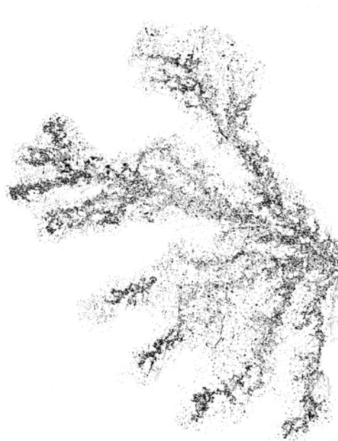
Рис. 7. То же изображение, что и на рис. 6, после инверсии цвета и увеличения контрастности исходного изображения для улучшения качества и наглядности локальной структуры зоны эрозии. Размер изображения 7 \times 8,6 \text{ мм}^2 .
