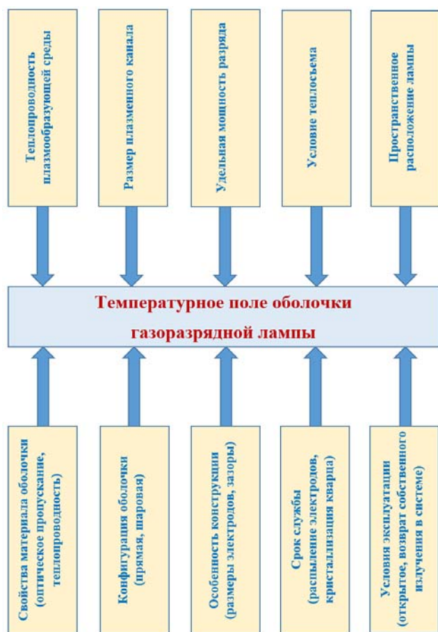
Рис. 11. Основные факторы, определяющие температурные поля оболочек газоразрядных источников излучения.
