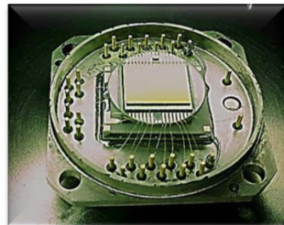
Рис. 1. МФПУ на основе гетероструктуры InGaAs, в корпусе, без входного окна.
