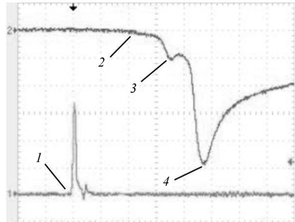
**Рис. 3.** Характерные осциллограммы процесса коммутации тока (луч № 1 – сигнал с фотодатчика, луч № 2 – токовый импульс) с указанием выделенных точек на осциллограмме коммутируемого тока: 1 – старт лазерного импульса; 2 – момент появления в разрядной цепи тока, заметного по величине при сравнении с амплитудным значением; 3 – особенность на осциллограмме (всплеск); 4 – момент достижения максимума тока в контуре. Развертка: 50 нс/дел.
