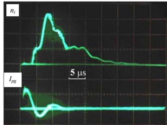
Рис. 3. Осциллограммы сигналов, иллюстрирующие генерацию импульсного потока внешней плазмы длительностью  $25 \text{ мкс}$ .
