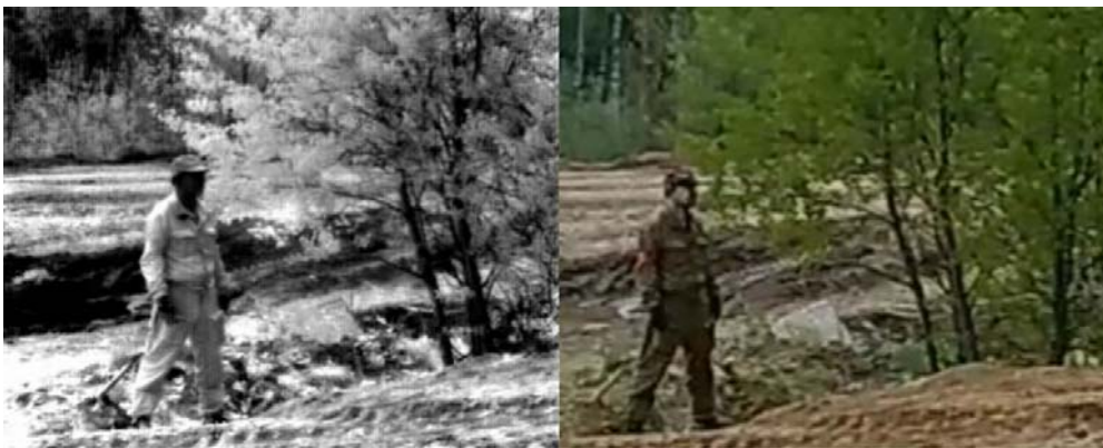
а) ИК – изображение, полученное с помощью ФПУ формата 640×512 элементов с шагом 15 мкм
