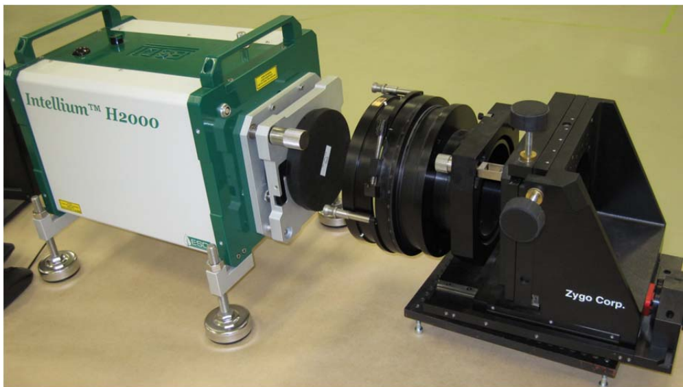
Рис. 10. Фотография лабораторного измерительного стенда на базе динамического интерферометра «IntelliumH2000» для апробации разработанного алгоритма определения СКО искажений волновых фронтов при контроле локальных отклонений профиля плоской эталонной поверхности диаметром 100 мм
