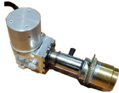
Рис. 10. Тепловизионный канал (а) и QWIP-фото модуль (б), входящий и его состав
