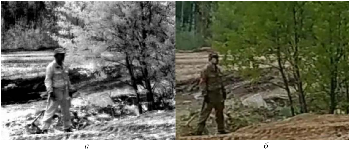
Рис. 16. Примеры изображений: a – ИК-изображение, полученное с помощью ФПМ формата 640 \times 512 элементов с шагом 15 мкм; б – видимое изображение, полученное с помощью кремниевой ПЗС-матрицы
