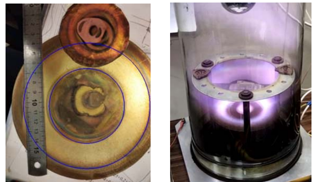
Рис. 11. Появление эрозии на латунном кольце (выделено синими линиями, слева) при проведении одного из экспериментов (слева) и сам эксперимент (справа)
