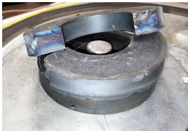
Рис. 2. Лопнувшая магнитная ловушка
