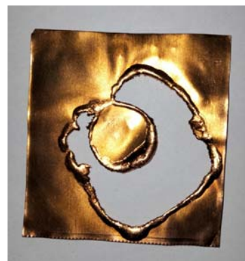
Рис. 9. Сама мишень после распыления МРС с подсистемой С.3 при неоднократном повторении эксперимента
