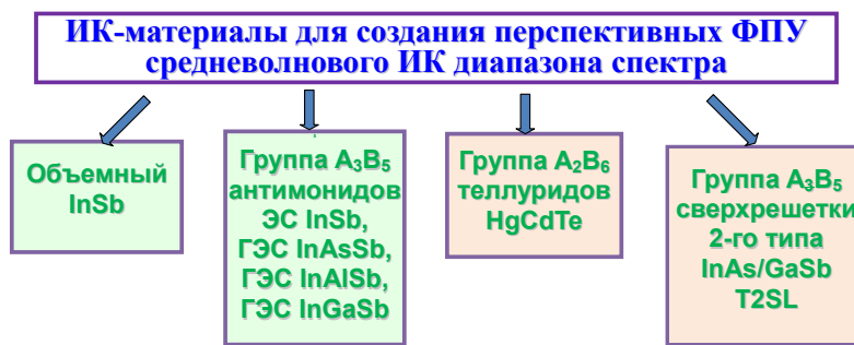
Рис. 1. Перспективные многослойные структуры и полупроводниковые материалы средневолнового инфракрасного диапазона спектра
