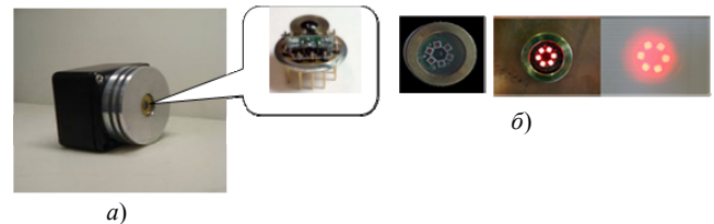
Рис. 7. Внешний вид пирометрического сенсора (а) и встроенного в корпус ФД оптического визира в режиме выкл./вкл. и в плоскости фокусировки на объект в оптических схемах с линзовым или зеркальным объективами
