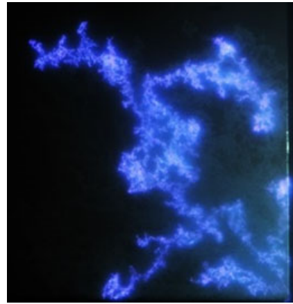
Рис. 2. Свечение микроплазменного разряда на поверхности пластины из титана, покрытого оксидной пленкой толщиной 2–6 нм. Разряд инициируется потоком внешней плазмы ( 2 \times 10^{13} см -3 ) справа и далее поддерживается в течение 1–2 мс источником импульсного электрического тока 50 А. Размер изображения 17,5 \times 17,5 мм 2
