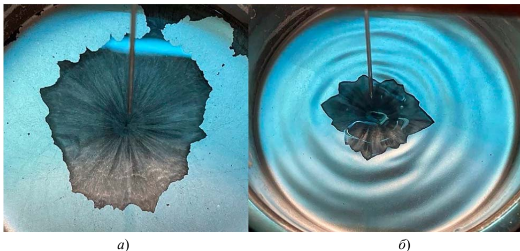
Рис. 4. Воздействие разряда на жидкость, покрытую алюминиевым порошком. а) – смесь спирта и глицерина 1:1, U = 18,4 кВ, I = 96 мкА, положение иглы над жидкостью h = 7 мм; б) – спирт U = 15,4 кВ, I = 81 мкА, положение иглы над жидкостью h = 7 мм
