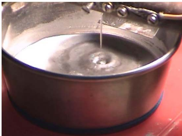
Рис. 3 Возмущение на поверхности спирта, покрытого алюминиевым порошком. Глубина спирта 12 мм, высота верхнего электрода над поверхностью жидкости 7 мм
