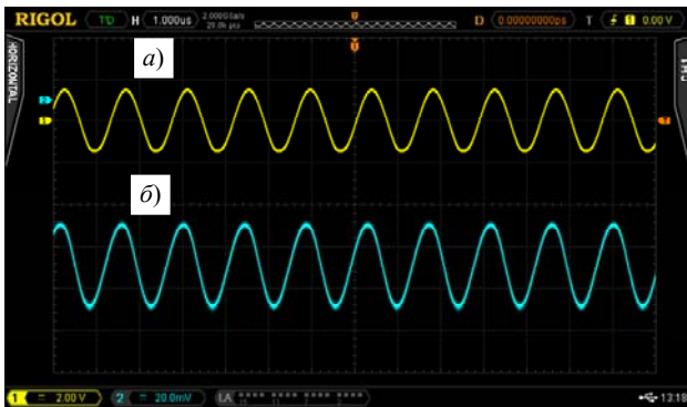
Рис. 2. Осциллограммы модулирующего гармонического колебания (а) и гармонического колебания на выходе демодулятора (б)
