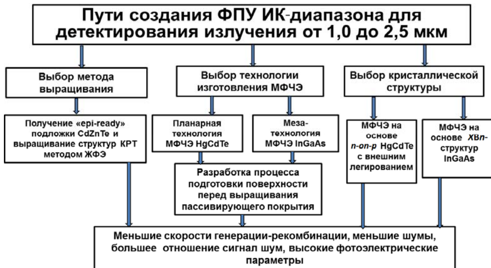
Рис. 1. Пути создания многоэлементных ФПУ на основе гетероструктур InGaAs и HgCdTe для детектирования ИК-излучения в области спектра от 1 до 2,5 мкм
