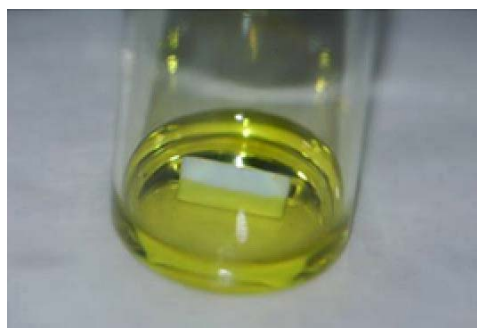
а) метиламмоний ( \text{CH}_3\text{NH}_3\text{I} ) и иодид свинца \text{PbI}_2 в растворе \gamma -бутиролактона
