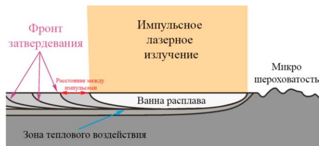
Рис. 7. Принцип лазерной полировки импульсным лазерным излучением [43]
