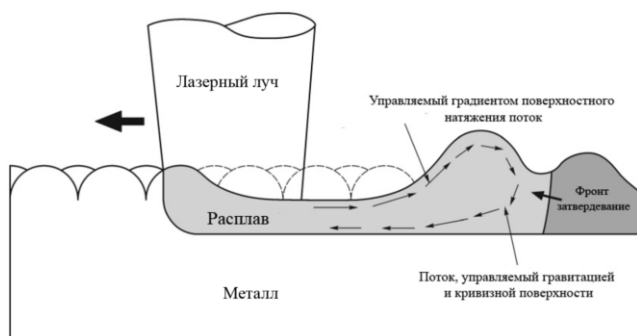
Рис. 8. Механизм лазерной полировки непрерывным лазерным излучением [46]
