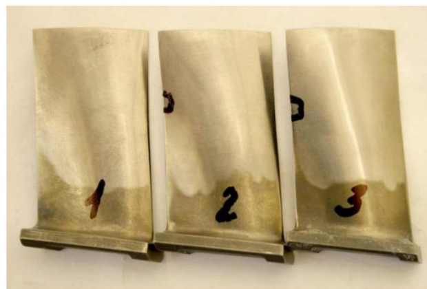
Рис. 9. Авиационные лопатки после лазерной наплавки и механической обработки [54]
